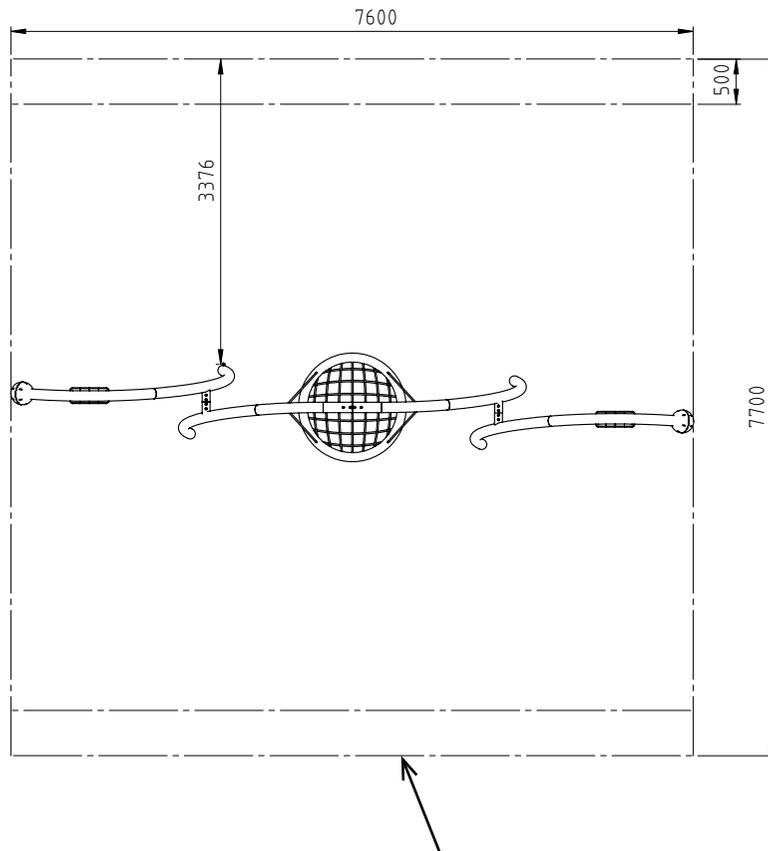
Aufprallfläche bei Verwendung von Naturböden mit stossdämpfender Wirkung.
